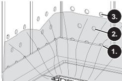
**Empfehlung:** Die Asche auf der Brennkammer nicht bei jedem Anheizen entfernen, sondern nur wenn die mittlere Lochreihe (2) der Brennkammerschürzen nicht mehr sichtbar ist. Durch eine gleichmäßige Ascheschicht wird die Brennkammer geschützt und das Anheizen funktioniert besser.
