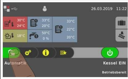
Je nach Kesseltype stehen mehrere Betriebsarten zur Verfügung, welche direkt am Grundbild des Touchdisplays geändert werden können.
