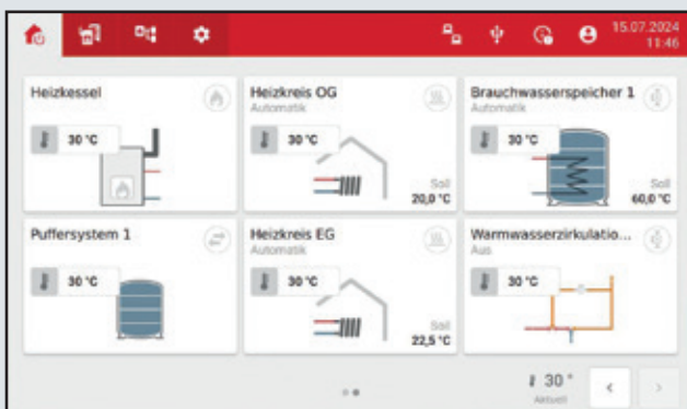
Übersicht der installierten Anlagen in Kacheldarstellung
