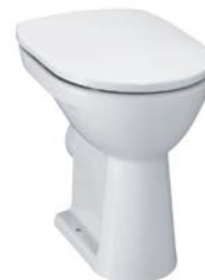
Stand-WC ‚comfort‘, Flachspüler, mit Spülrand, Abgang waagrecht / senkrecht, Sitzhöhe (inkl. Sitzring) 48 cm
