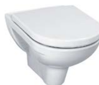
Wand-WC, Tiefspüler, mit Spülrand (Steinschraubenabstand 180 / 230 mm)
