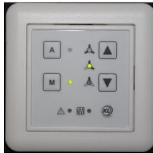
Bedienteil Mini **11BTM** für alle Lüftungsgeräte und KL-Boxen ermöglicht eine einfache Bedienung, Gehäuse für die Unterputzmontage aus Kunststoff, geeignet für Einbaurahmen von Berker und Gira, je 2 Stück Drucktasten für die Auswahl der aktuellen Luftstufe und des Manuell- und Automatikbetrieb, 6 Stück LED Leuchten für Luftstufe, Betriebsrat, Fehler- und Filteranzeige, Konfigurationsmöglichkeit über Tastenkombinationen und Blinkmuster, Darstellung der Fehlermeldungen erfolgt über Blinkmuster.
