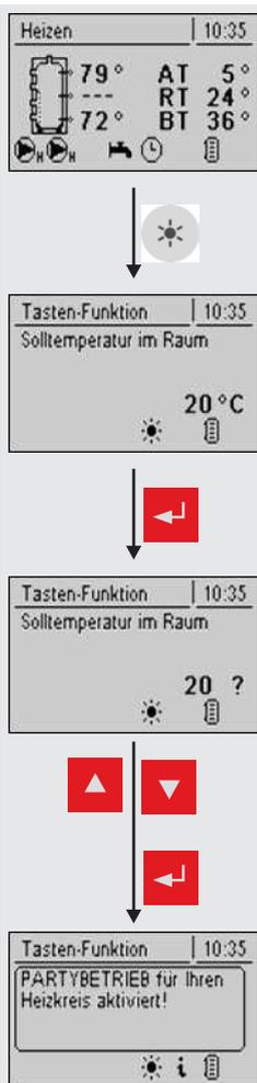
Nach dem Drücken der Partybetrieb-Taste wird am Display ein Eingabefeld zur optionalen Änderung der „Solltemperatur im Raum“ angezeigt. Wird keine weitere Taste gedrückt, startet der Tagbetrieb bis zum Ende der nächsten Heizphase oder bis zur Aktivierung des Automatikbetriebs, für den zugeordneten Heizkreis, mit der voreingestellten Raumsolltemperatur.
