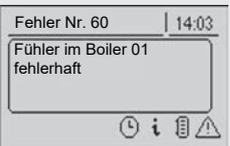
Wurde eine Störung nach dem Auftreten zwar quittiert, aber nicht behoben, wird dies durch ein Warnsymbol rechts unten in der Statuszeile angezeigt.
